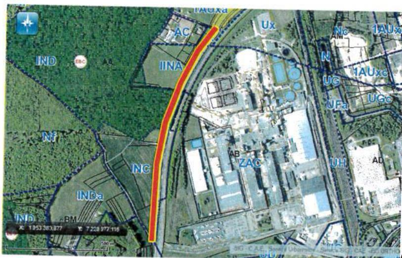
Contre-allée de 1110 mètres de long nécessitant « a minima » 30 mètres de large (chaussée et noue).
